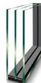
Triple vitrage feuilleté ép. 40 mm (44,2/12/6/10/4)
