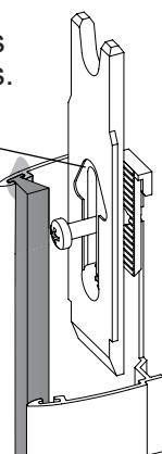
9 Serrer les vis jusqu'à arriver en butée sur les targettes.
