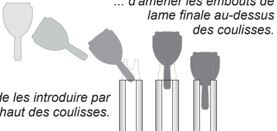
... d'amener les embouts de lame finale au-dessus des coulisses.
