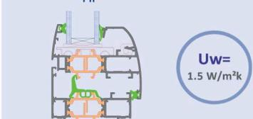
Seuil 20 mm en conformité avec le DTU 36.5 et les directives du CSTB
