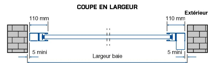
**Largeur de commande :**  $L \text{ baie} - 230 \text{ mm}$
