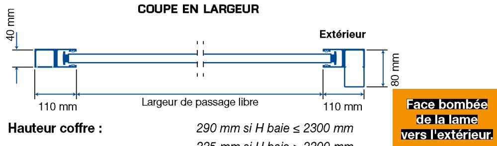
**Attention :** La porte se pose sur sol fini. Le relevé de cotés doit être réalisé en conséquence.
